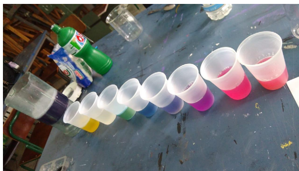
Figura 3 - Resultado de experimento com indicador de repolho roxo em soluções ácidas e básicas
