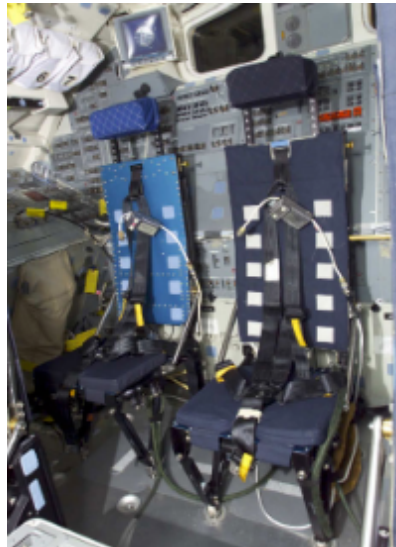
Figura 29 – fotos que demonstram a fragilidade dos assentos no cockpit: extremamente finos, desconfortáveis, não ergonômicos, sem proteção lateral para a cabeça, sem dispositivos pirotécnicos para escape balístico por paraquedas.
