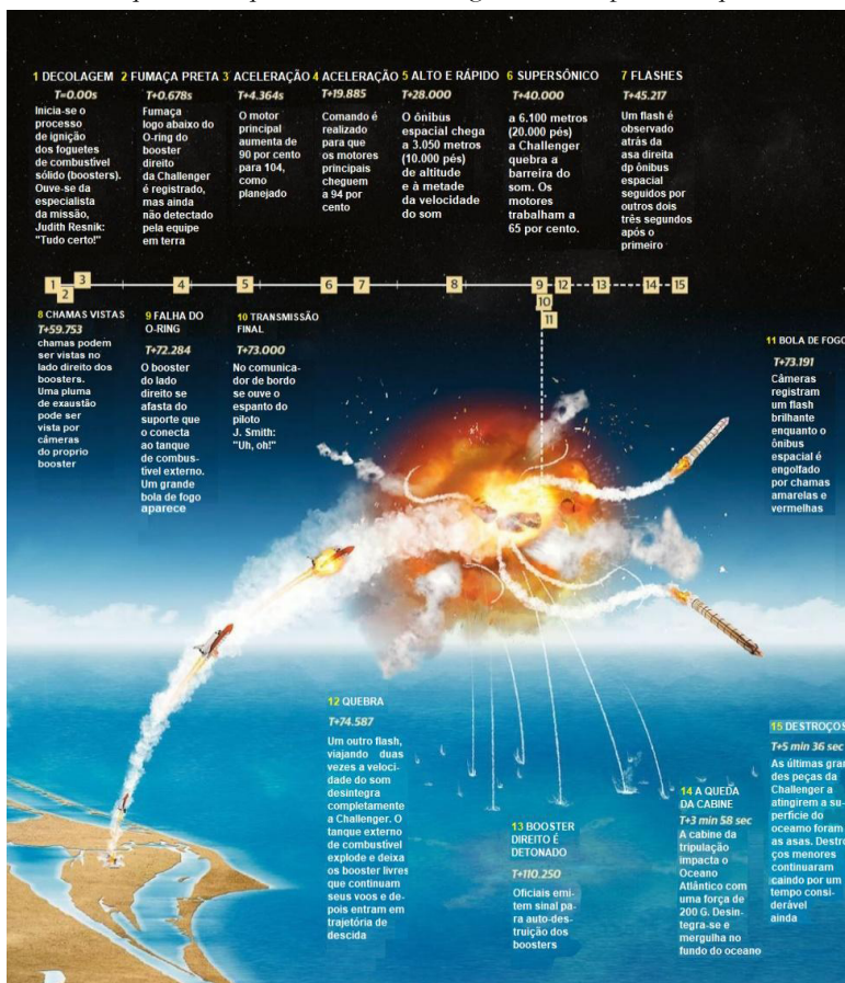
Figura 10c – A sequência esquemática da decolagem até a explosão e queda dos destroços.
