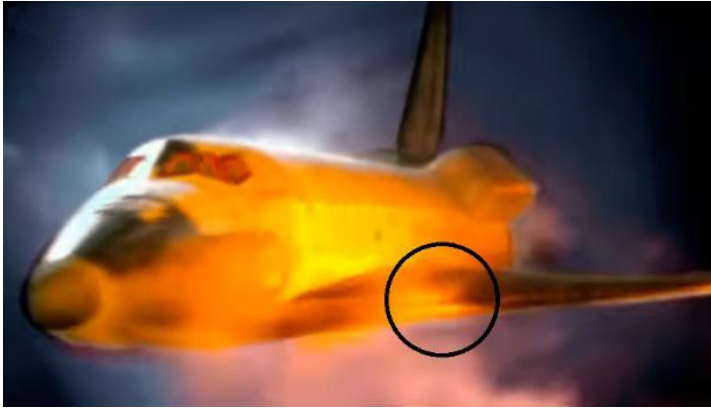
Figura 18 – O círculo marca a parte da asa afetada durante a decolagem do Columbia: o choque de um pedaço de uma esponja térmica que recobria o tanque externo de combustível líquido contra a asa.
