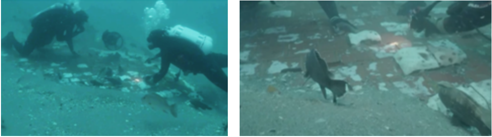
Figura 16 - Descobertos no fundo do mar, em 2022, destroços da Challenger relativas à parte inferior da nave, com os ladrilhos cerâmicos ainda presos ao que restou da fuselagem.
